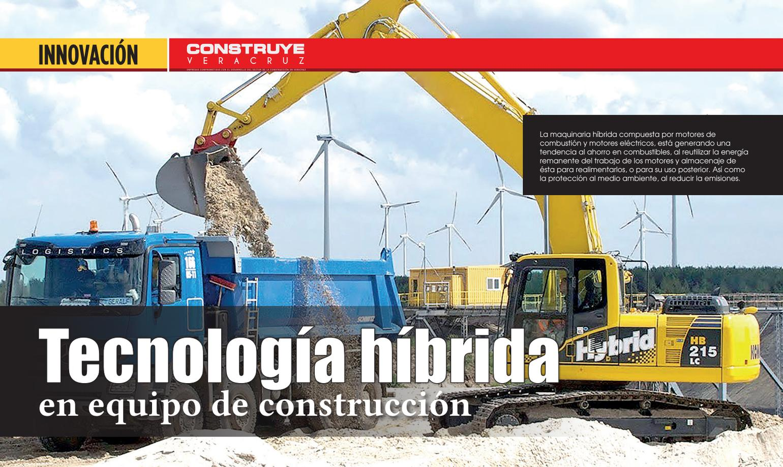
La maquinaria híbrida compuesta por motores de combustión y motores eléctricos, está generando una tendencia al ahorro en combustibles, al reutilizar la energía remanente del trabajo de los motores y almacenaje de ésta para realimentarlos, o para su uso posterior. Así como la protección al medio ambiente, al reducir la emisiones.
